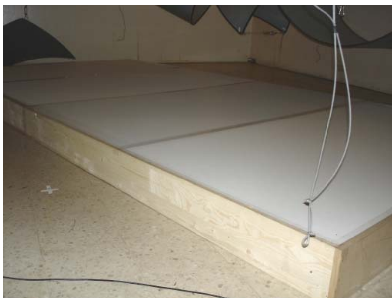
Beispiel Akustikplatte Typ 1 auf dem Hallraumboden
